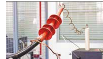
Высоковольтные испытания кабельных муфт
